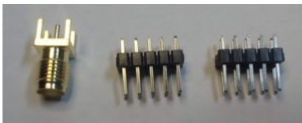
Verbinder und Antennenanschluß
